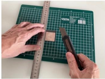
Os protetores plásticos devem ser cortados com um estilete, deixando uma borda de 1 mm das margens do selo.
