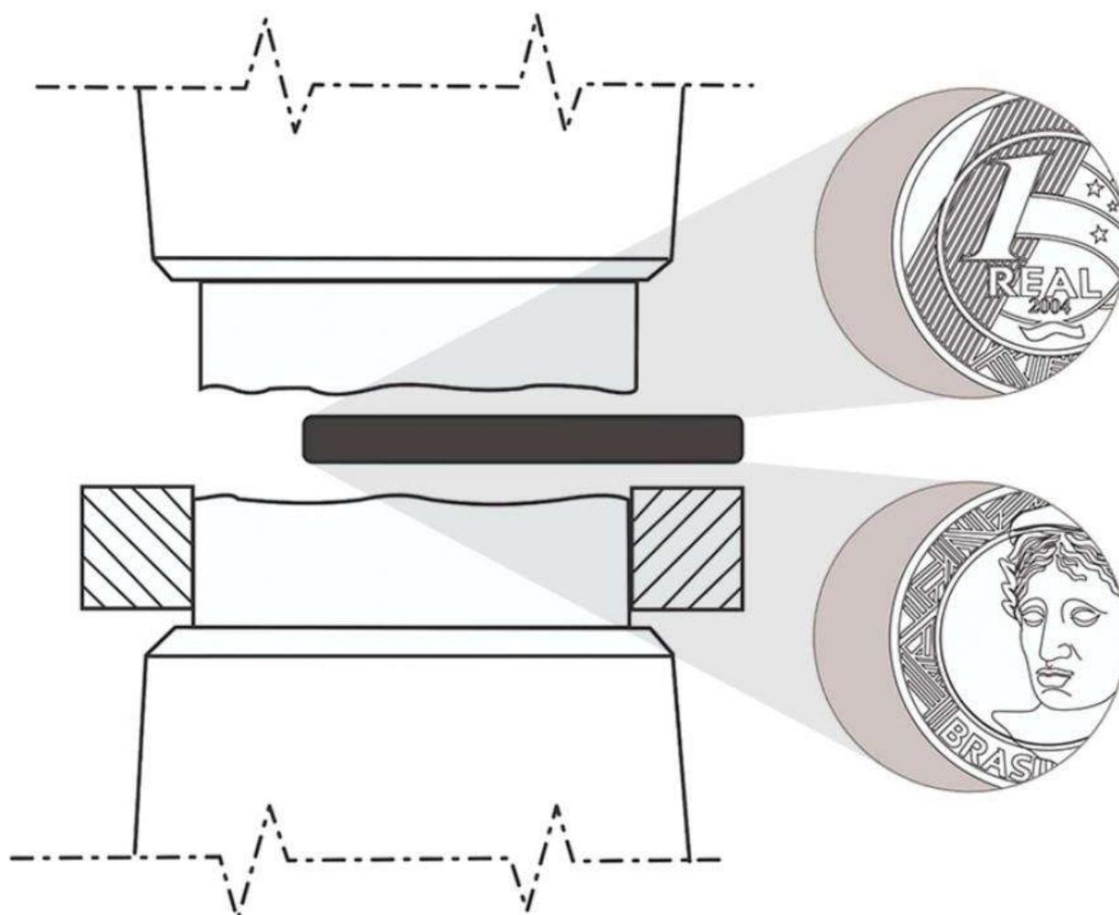
Ilustração de cunhagem de uma moeda com disco descentralizado ou boné, os cunhos ficam no mesmo lugar, mas o disco está introduzido fora do centro da cunhagem
