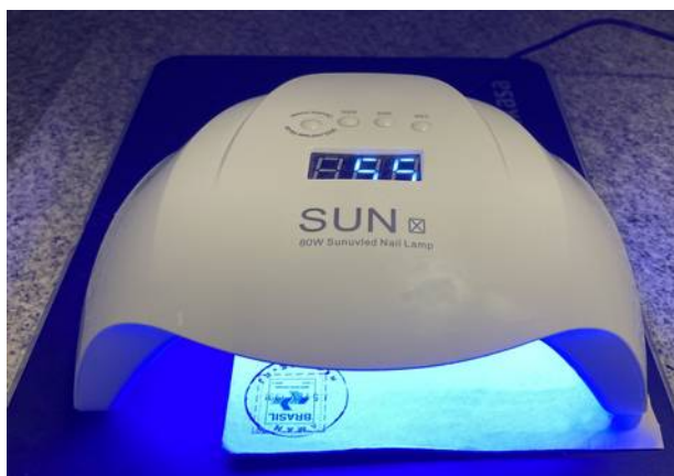
Câmara de luz UV, para observar selos postais impressos com pigmentos fosforescentes.
