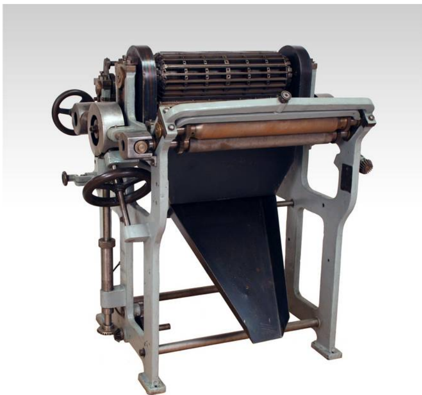
Máquina rotativa para perfurar selos, fabricada em 1918 pela Crown Cork & Seal Company.
