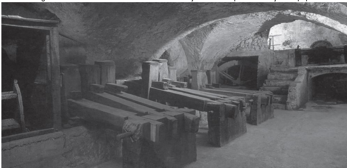
Figura 127 – Moinhos de martelo movidos à força hidráulica para fabricação de papel
