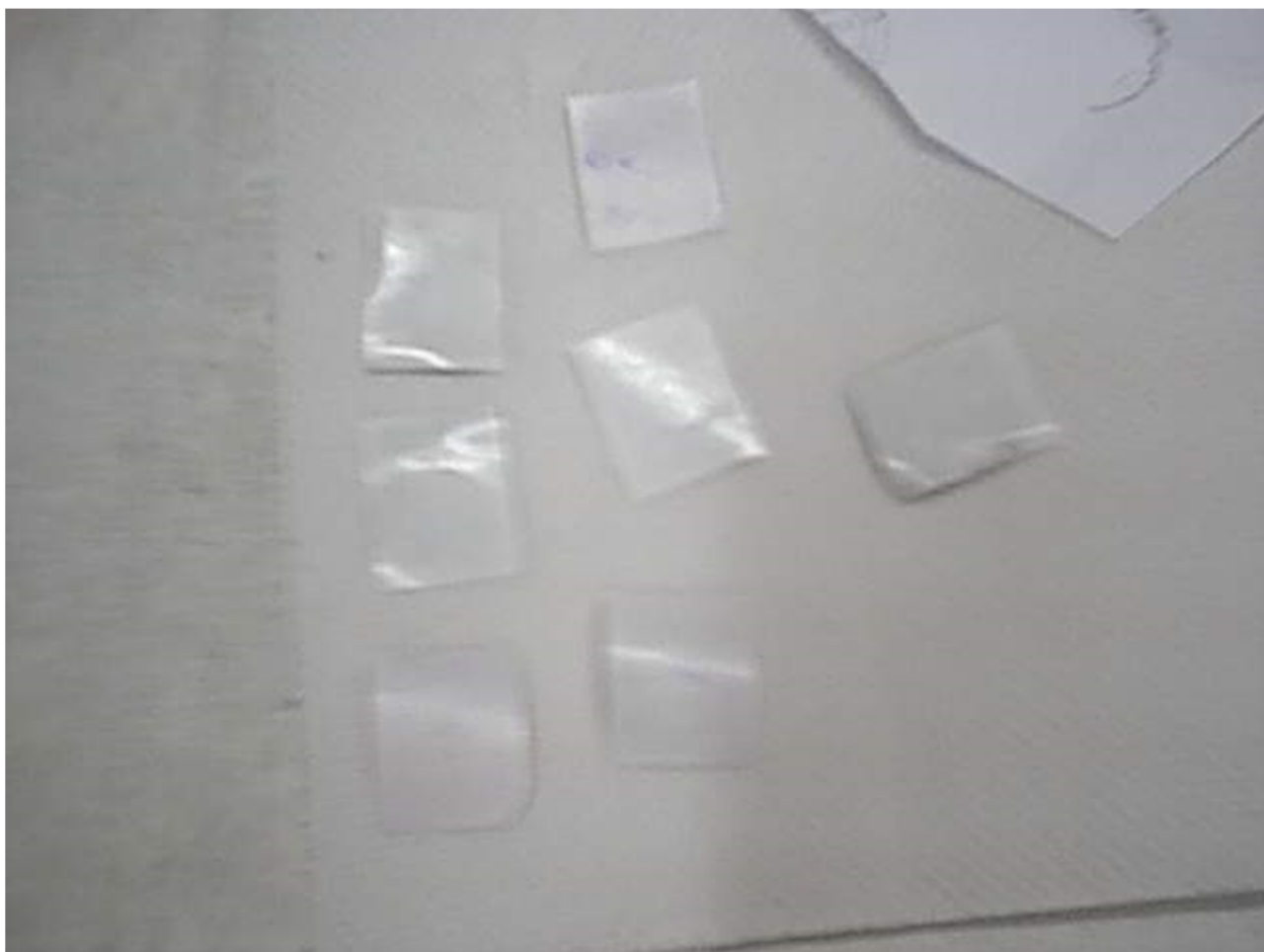
Fig 6 Selos autoadesivos depois de descolados com benzina, voltados com a goma para cima.
